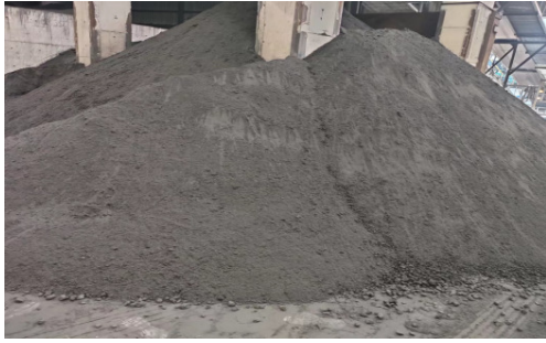
图5 破碎后的超高压压滤煤泥
