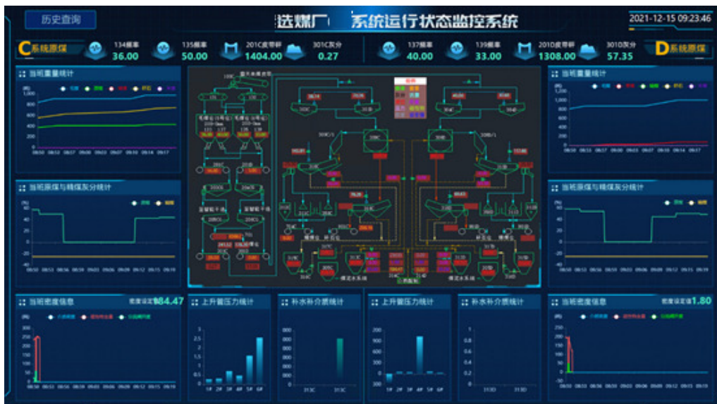
图 2 浅槽重介智能系统的数据展示
