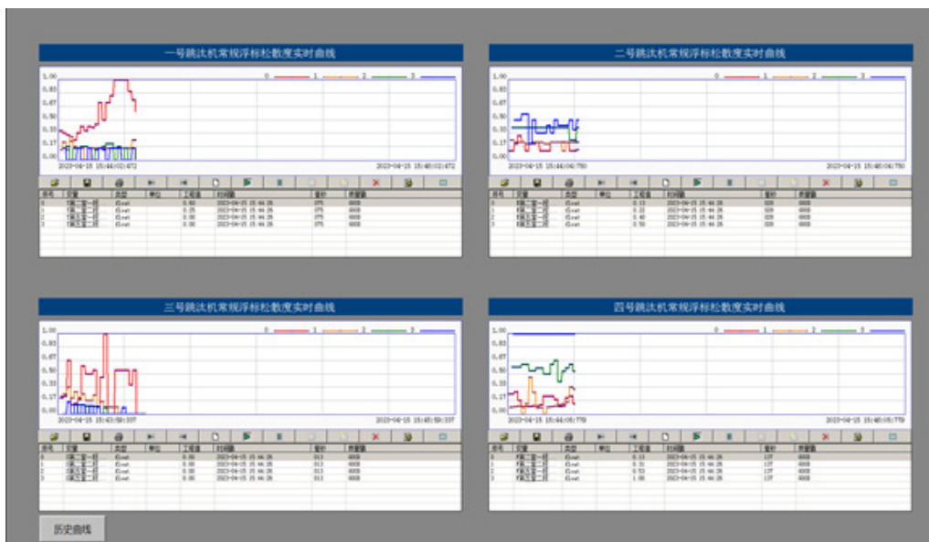
图 3 跳汰床层松散度实时曲线示例
